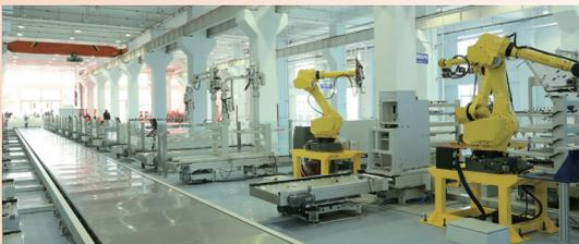
▲ 双杰电气智能型固体绝缘开关柜全自动化生产线
